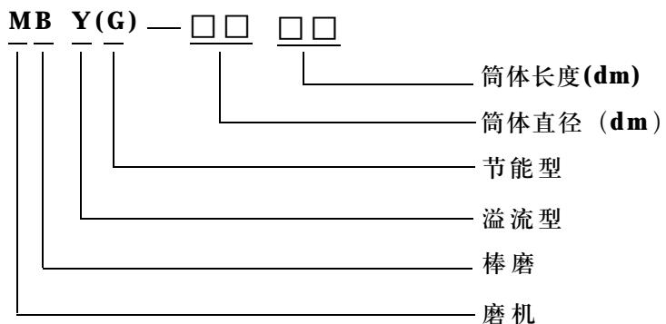
示例：筒体直径为 2700 毫米，筒体长度为 3600 毫米的棒磨机，表示为 **MBY2736** 溢流型棒磨机。
